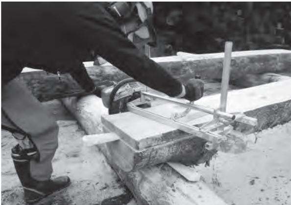
▲チェーンソー製材機を使って、丸太を板に加工する谷野隊員
