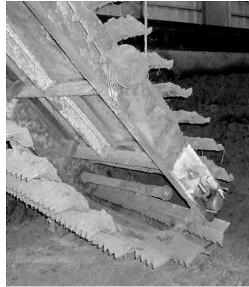
かくはん機の故障 (コンベアー主軸破損)
