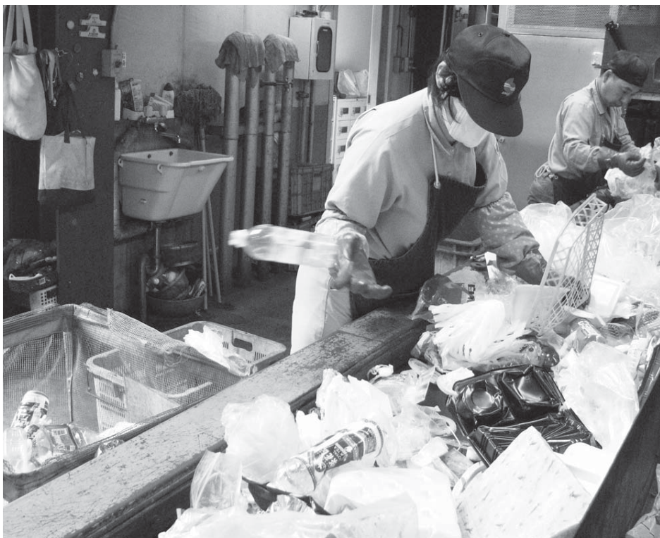
▲大量のプラスチックごみの中から再生できるペットボトルを選別する作業
