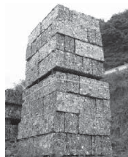
▲1ブロックで約1t、350ccのアルミ空き缶約6万個分
